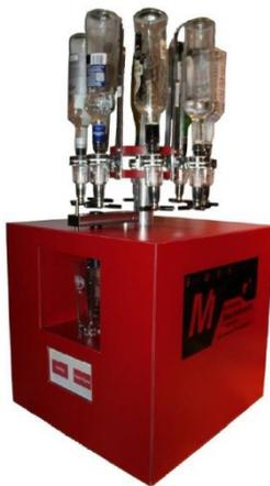
Um die Maschine zu bauen, wurden sechs gleich große Holzplatten zum Würfel verschraubt, um als Gehäuse für Säfte, flüssigkeitsführende Armaturen und der Elektronik zu dienen. Daran befestigt sind die Flaschenhalter und das Revolvermagazin. An der Frontplatte der Maschine befinden sich zwei Aussparungen für das Display und die Glasaufnahme. An der Seitenplatte dient eine kleine Öffnung mit Magneten und Scharnieren als Tür zum Befüllen der Cocktailmaschine mit neuen Säften.
